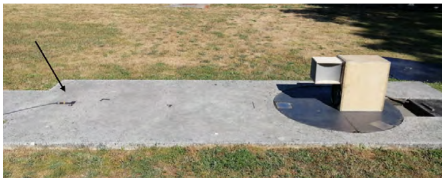
图 3 典型的用于测量声损耗的室外装置。箭头所指的是麦克风的位置。
