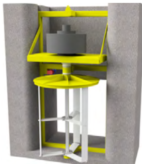
图 4 Water2Energy 水力涡轮机设计示意图。包括垂直叶片 (以白色显示) 的转子机构。
