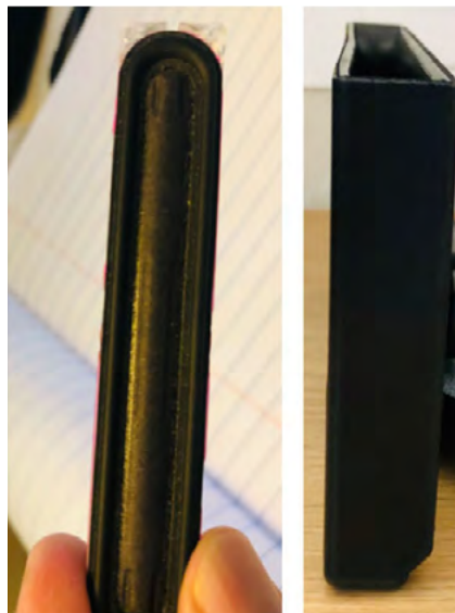
图 5 超薄微型换能器的原型 (左) 和厚度为 1 英寸 (约 2.5 厘米) 的超薄杜比全景声扬声器 (右)。
