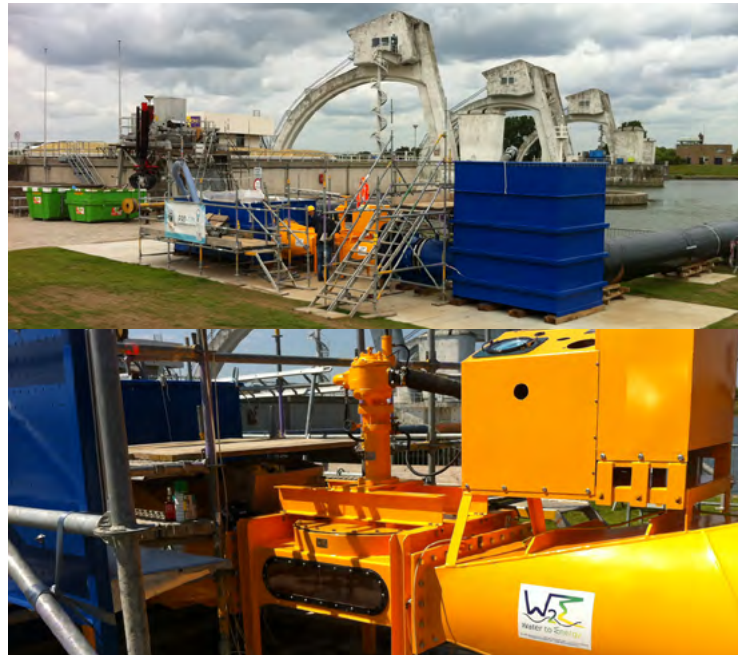
图 7 Water2Energy 水力涡轮机原型,即将进行现场测试。
