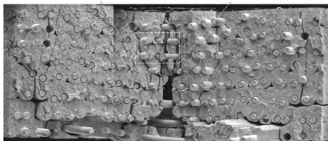
图3 钨-纤维增强钨材料(W f /W)中孔隙的形成。
