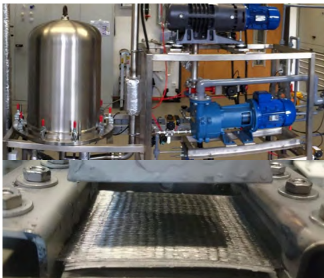
图2 化学气相沉积(CVD)生产设备的外部(上)和内部(下)。
