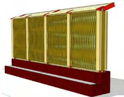
图 5 城市绿色屏障的最终设计图。钢底座和结构框架支撑了柳木覆盖的矿物棉块和屋顶/檐沟组件。图片由 TL-Engineering 提供。
