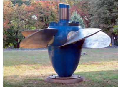
图 2 Kaplan 涡轮转子示例。图片由 Reinraum, CC0 提供，通过 Wikimedia Commons 获得许可。
