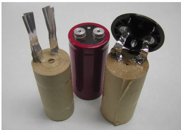
图 20 铝电解电容器由铝箔和具有热学各向异性的纤维素隔膜卷绕组成。
