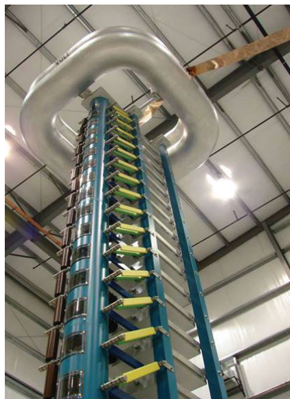
图 1. NTS 运营的高压发生器 (2.4 MV 的马克思发生器)。
