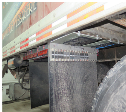
图 2. 上: 经过一年在役暴露实验后, 由碳纤维增强聚合物 (carbon-fiber-reinforced polymer, 简称 CFRP) 和 6000 系列铝合金制成的多材料叠加式装配制成的车身上的电偶腐蚀情况。下: 用于车辆运行测试的汽车样件常见安装方式。
