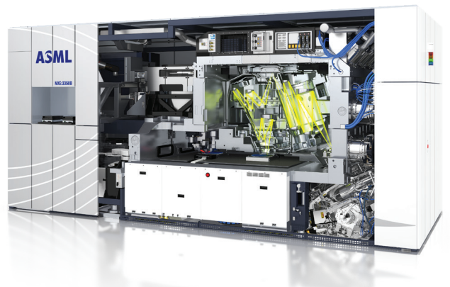
图2. ASML® TWINSKAN® NXE:3350B 型 EUV 生产系统, 采用 13.5 nm 波长的极紫外光, 每小时可制造 125 个计算机晶圆。它在高载荷下快速移动晶圆时必须维持绝对真空状态, 并确保晶圆扭曲始终小于 1 nm。
