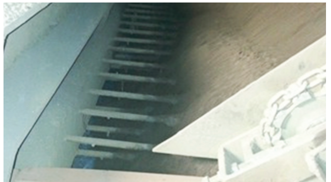
图 5. 烧结厂给料系统, 安装了两排水平松料棒。
